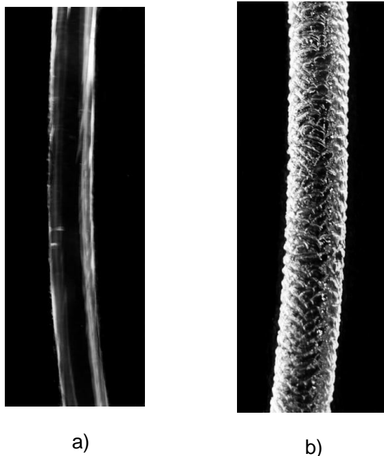
Rys. 1. Przykład wytłoczyny z polietylenu w trakcie przepływu stabilnego (a) oraz w zakresie występowania niestabilności przepływu typu skóra rekina (b) [opracowanie własne]
