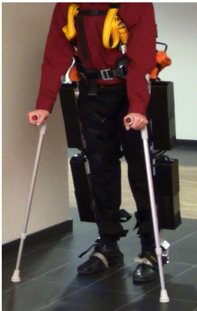
Rys. 1. Konstrukcja prototypu egzoszkieletu kończyn dolnych, opracowanego w zespole Biocybernetyki IAiII (fot. Mateusz Kowalski).
